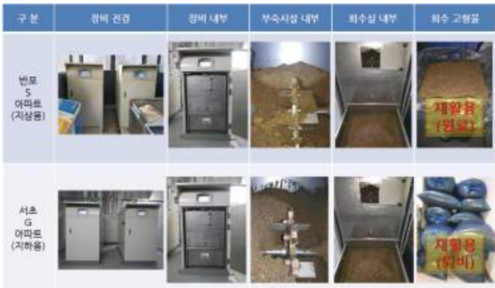
〈그림 3-6〉 건조퇴비화 장치 내부 및 회수 고품물
