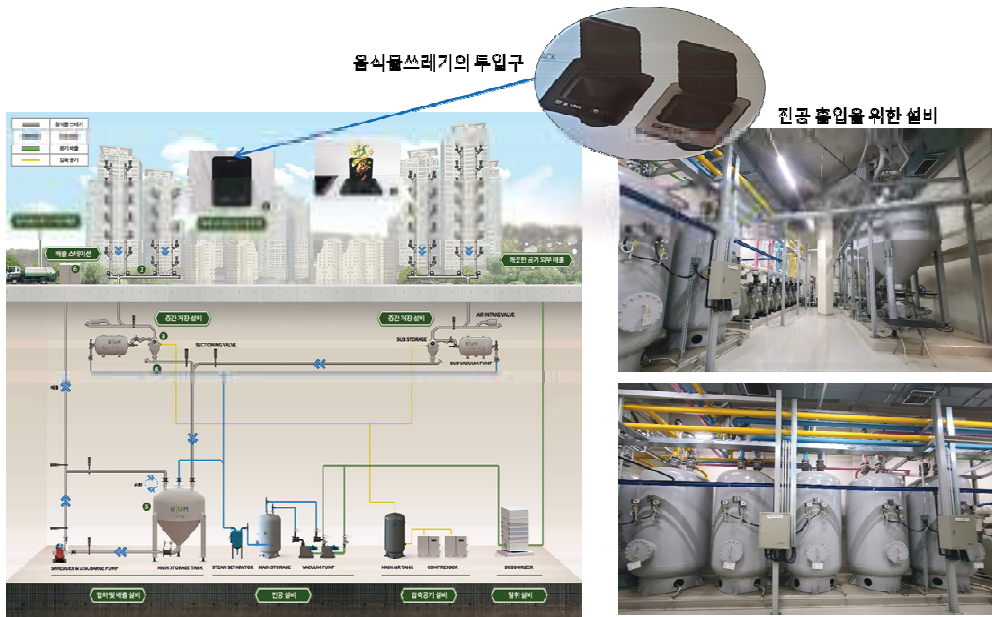
〈그림 3-7〉 진공압력을 이용한 음식물쓰레기 관리이송시스템
